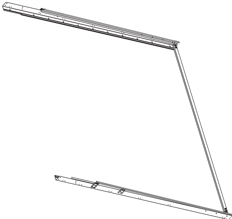
Рис. 8. Вертикальная рамка несущего каркаса в сборе
